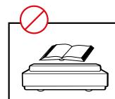
No debe colocarse ningún objeto encima o delante de la lente porque la luz del láser calentaría mucho ese objeto. ¡Peligro de incendio!
