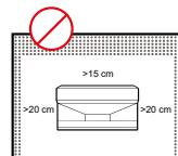
Per garantire una sufficiente ventilazione del proiettore, occorre mantenere le distanze minime prescritte (vedi figura).
