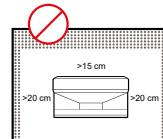
Voor voldoende ventilatie moeten de voorgeschreven afstanden (zie afbeelding) worden aangehouden.
