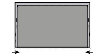
Se i piedini di supporto posteriori hanno già raggiunto la loro altezza massima e non possono essere svitati ulteriormente, si può ripiegare avvitando i due piedini di supporto anteriori
