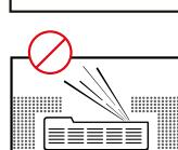
Le vidéoprojecteur laser ne doit pas être installé dans un espace clos dont la ventilation est limitée. Cela provoquerait une surchauffe.
