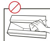
Нельзя касаться объектива руками или обтирать его протирочной тряпкой. Иначе можно повредить оптическое покрытие, что негативно скажется на качестве изображения.
