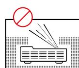
U mag de laser-TV niet in een afgesloten ruimte met weinig ventilatie plaatsen. Dan ontstaat er oververhitting.
