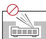
Das Laser-TV darf nicht in einem umschlossenen Raum mit eingeschränkter Belüftung aufgestellt werden. Dies würde zur Überhitzung führen.
