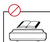
Aucun objet ne doit être placé au-dessus ou devant la lentille, car la lumière laser chaufferait alors fortement l'objet. Risque d'incendie !
