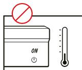
Das Laser-TV darf nicht eingeschaltet werden, wenn die Temperatur unter 5 °C oder über 40 °C liegt.
