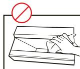
Das Objektiv darf nicht mit den Händen berührt oder mit einem Reinigungstuch abgewischt werden. Die optische Beschichtung wird sonst beschädigt, was die Bildqualität beeinträchtigt.
