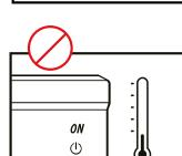
Ne pas allumer le vidéoprojecteur laser si la température est inférieure à 5 °C ou supérieure à 40 °C.
