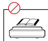
U mag geen voorwerpen boven of vóór de lens plaatsen, omdat dan het laserlicht dit voorwerp sterk verhit. Brandgevaar!
