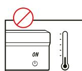
El Laser-TV no debe conectarse cuando la temperatura sea inferior a 5 °C o superior a 40 °C.
