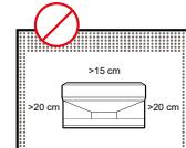
Чтобы у прибора была достаточная вентиляция, следует соблюдать указанные расстояния (см. рис.).
