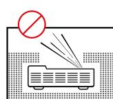
Il Laser TV non deve essere installato in uno spazio racchiuso e scarsamente ventilato. Si provocherebbe un surriscaldamento del proiettore.
