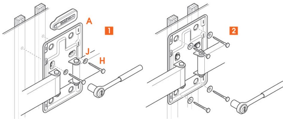
4. Befestigen Sie die **Wandhalterung** (A) mit den **Schrauben** (H), den **Unterlegscheiben** (J) und den **Dübeln** (I) an der Wand. Mit der **Wasserwaage** sorgen Sie für eine waagerechte Montage der **Wandhalterung** (A). Achten Sie darauf, dass Sie die beiden mittleren Schrauben zuerst in die Wand schrauben.
