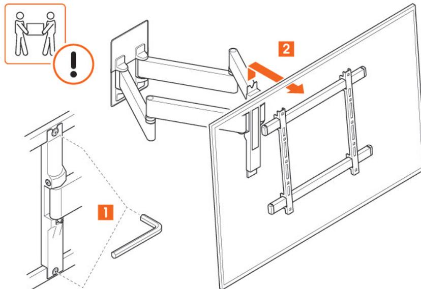
1. Entfernen Sie den unteren Adapterbolzen und lösen Sie den oberen Adapterbolzen. Ziehen Sie an der Schnur zur Entriegelung, um den Fernseher zu entriegeln.
