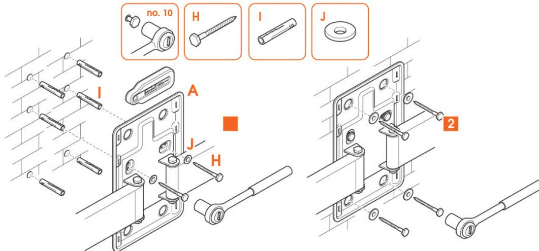
3. Befestigen Sie die **Wandhalterung** **A** mit den **Schrauben** **H**, den **Unterlegscheiben** **J** und den **Dübeln** **I** an der Wand. Mit der **Wasserwaage** sorgen Sie für eine waagerechte Montage der Wandhalterung. Achten Sie darauf, dass Sie die beiden mittleren Schrauben zuerst in die Wand schrauben.
