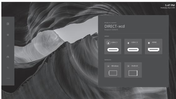
Die Eingangsquelle wird im Dashboard automatisch erkannt und es wird direkt zum Gerät gewechselt. Es kann sowohl zu Audio als auch zu Video gewechselt werden.
