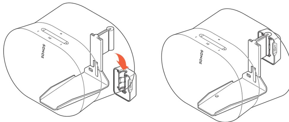
1. Heben Sie den Lautsprecher an und setzen Sie das **Neigungsmodul** ① in die **Wandhalterung** ②.
