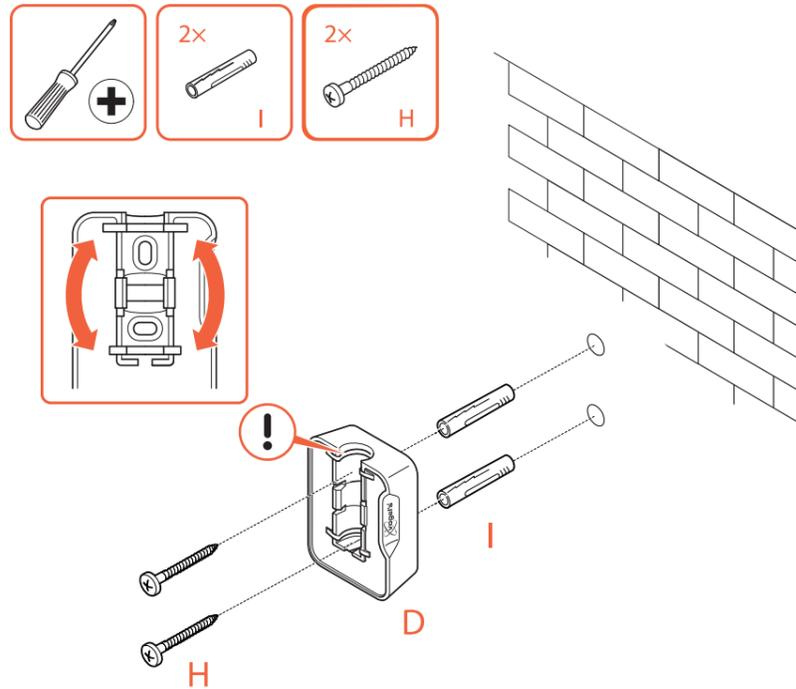
5. Befestigen Sie die **Wandhalterung** ⊕ mit den **Schrauben** ⊕ und den **Dübeln** ⊕ an der Wand. Verwenden Sie die integrierte Wasserwaage, um die **Wandhalterung** ⊕ zu neigen, bis sie waagrecht ist.
