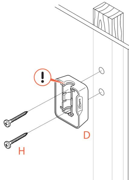
6. Befestigen Sie die **Wandhalterung** ② mit den **Schrauben** ③ an der Wand. Verwenden Sie die integrierte Wasserwaage, um die **Wandhalterung** ② zu neigen, bis sie waagrecht ist.
