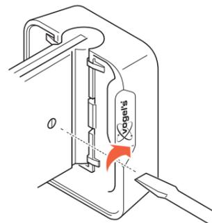
3. Befestigen Sie den Lautsprecher, indem Sie die Stellschraube an der Seite des **Neigungsmoduls** anziehen ③.
