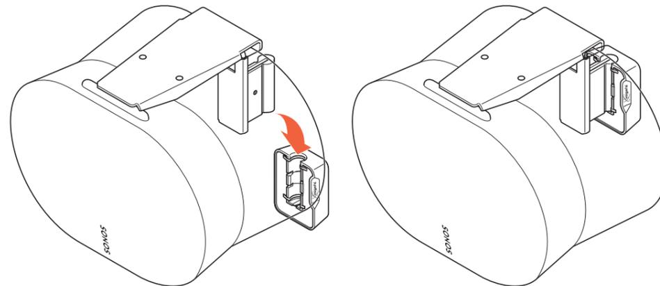
1. Heben Sie den Lautsprecher an und setzen Sie das **Neigungsmodul** ④ in die **Wandhalterung** ⑤.
