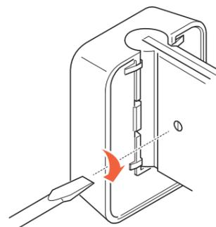
3. Befestigen Sie den Lautsprecher, indem Sie die Stellschraube an der Seite des **Neigungsmoduls** anziehen ④.
