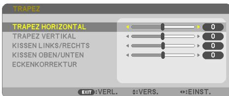
Sie können die horizontale oder vertikale Trapezverzerrung, die Kissenverzerrung RECHTS/LINKS oder OBEN/UNTEN oder die Eckenverzerrung manuell korrigieren.
