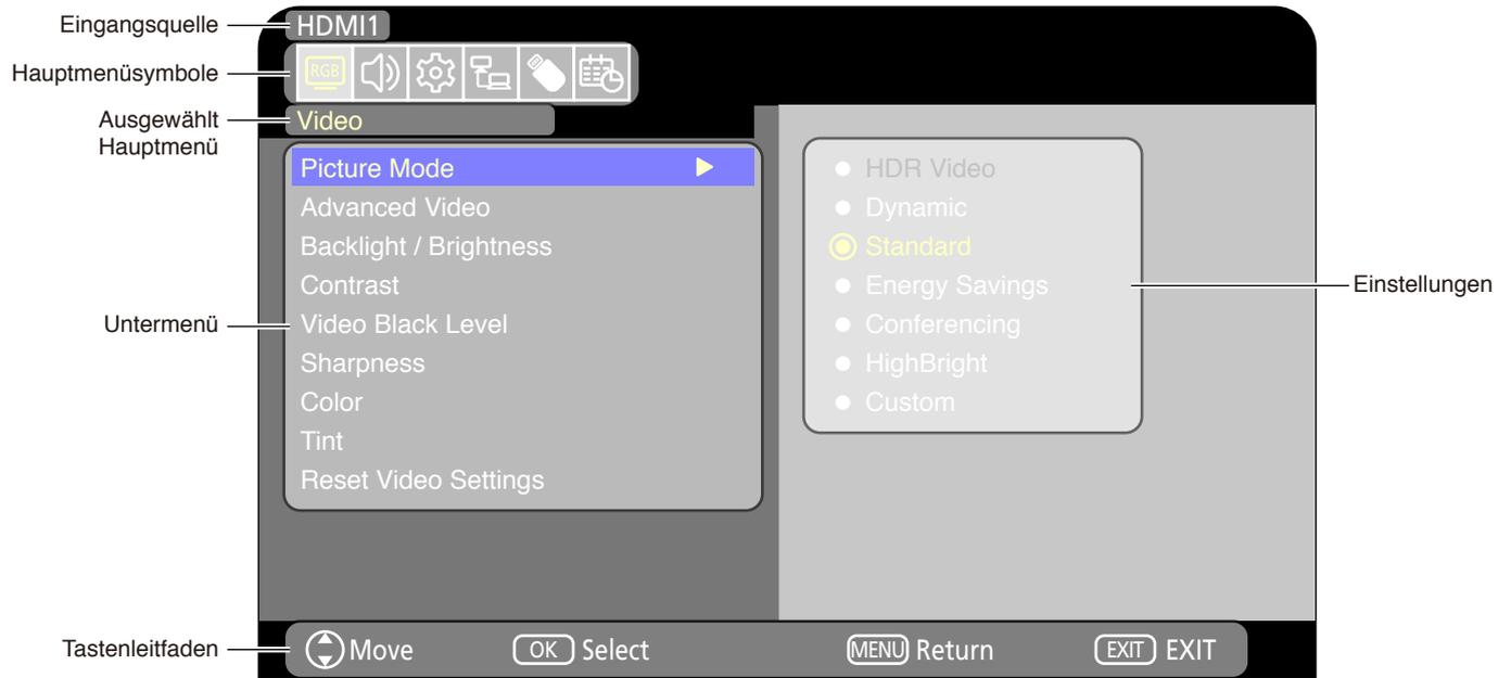
MENU drücken, um das OSD-Menü zu öffnen und zu schließen. Drücken Sie die Taste EXIT, um das OSD-Menü zu schließen und den OSD-Betrieb zu beenden.
