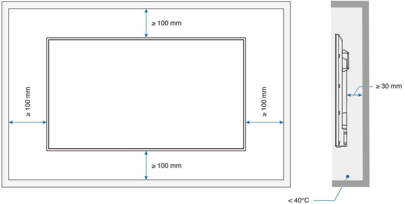
**HINWEIS:** Die maximale Umgebungs-Betriebstemperatur des Monitors beträgt  $40^\circ\text{C}$ . Dieser Monitor ist mit internen Temperatursensoren ausgestattet.
