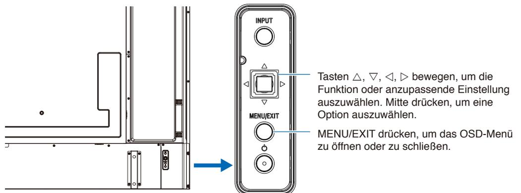
Die Funktion der einzelnen OSD-Menüelemente wird im Folgenden kurz erläutert. Weitere Einzelheiten zum Inhalt des Menüs finden Sie unter „Liste der OSD-Steuerelemente“ ([Seite 71](#)).
