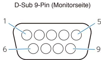
Dieser Monitor verwendet RXD-, TXD- und GND-Leitungen für die RS-232C-Steuerung.
