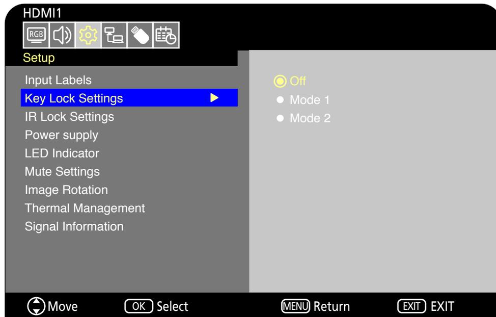
1. Gehen Sie im OSD-Menü zu [Setup (Einrichtung)] -> [Other settings (Andere Einstellungen)] -> und wählen Sie dann [Key Lock Settings (Tastensperre Einstellungen)].
