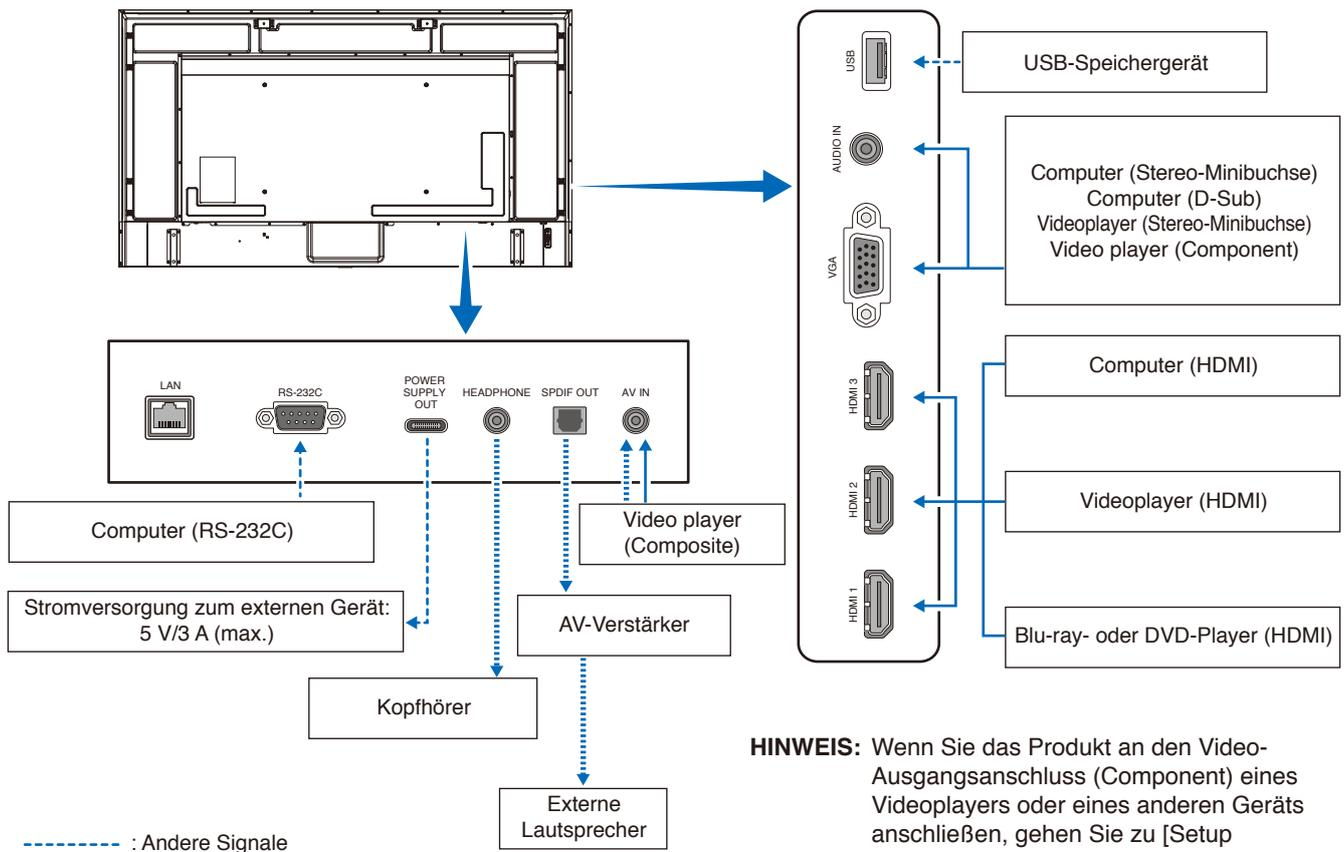
**HINWEIS:** Wenn Sie das Produkt an den Video-Ausgangsanschluss (Component) eines Videoplayers oder eines anderen Geräts anschließen, gehen Sie zu [Setup (Einrichtung)] im OSD-Menü -> [VGA Options (VGA-Optionen)] -> [VGA Mode (VGA-Modus)] und wählen Sie [YPbPr (YPbPr)].
