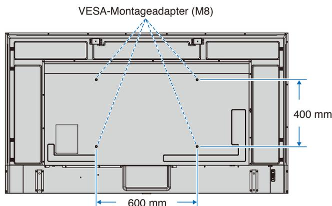
Montagezubehör kann an den Monitor angebracht werden, wenn dieser mit der Vorderseite nach unten liegt. Bevor Sie den Monitor mit der Vorderseite nach unten ablegen, legen Sie stets ein weiches Tuch auf den Tisch, z. B. eine Decke, die größer als der Monitor ist. So vermeiden Sie Kratzer auf dem LCD-Panel. Stellen Sie sicher, dass sich nichts auf dem Tisch befindet, was den Monitor beschädigen kann.
