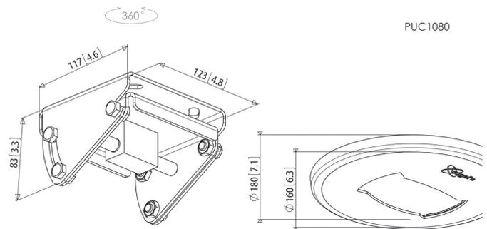
"Diese Deckenkonsole ist für flache und geneigte Decken (bis 60°) geeignet. Das Display kann in jede erforderliche Position gedreht werden. Kombinieren Sie diese Deckenkonsole mit einem Rohr aus der Serie Connect-it (PUC 2508 / 2515 / 2530), einer Connect-it Adapterleiste (PFB 3405 / 3407 / 3409 / 3411) und einem Connect-it Displayadapter (PFS 3303 / 3304 / 3305 / 3306 / 3308 / 3311) zu einer Komplettlösung für die Deckenbefestigung.
