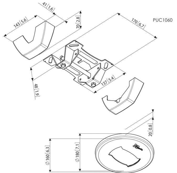
Diese Deckenkonsole ist für flache Decken geeignet. Kombinieren Sie diese Deckenkonsole mit einem Rohr aus der Serie Connect-it (PUC 2508, PUC 2515 oder PUC 2530), einer Connect-it Adapterleiste (PFB 3405, PFB 3407, PFB 3409 oder PFB 3411) und einem Connect-it Displayadapter (PFS 3303, PFS 3304, PFS 3305, PFS 3306, PFS 3308 oder PFS 3311) zu einer Komplettlösung für die Deckenbefestigung.
