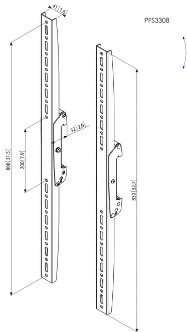
Le PFS 3308 convient pour les écrans de taille moyenne et grande pesant jusqu'à 80 kg avec un support de montage vertical max. de 800 mm. Pour une solution complète de montage au plafond, combinez ces languettes d'interface d'écran avec des plaques de plafond de la série Connect-it (PUC 1060/ 1070/ 1080/ 1090), un tube Connect-it (PUC 2508/ 2515/ 2530) et une barre d'interface Connect-it (PFB 3405/ 3407/ 3409/ 3411).
