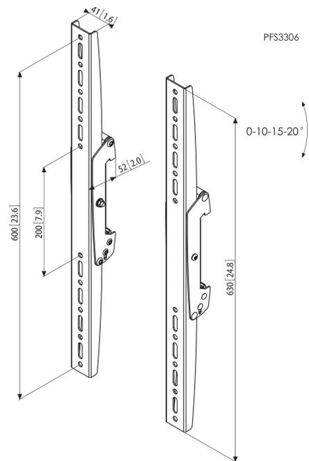
Le PFS 3306 convient pour les écrans de taille moyenne et grande pesant jusqu'à 80 kg avec un support de montage vertical max. de 600 mm. Pour une solution complète de montage au plafond, combinez ces languettes d'interface d'écran avec des plaques de plafond de la série Connect-it (PUC 1060/ 1070/ 1080/ 1090), un tube Connect-it (PUC 2508/ 2515/ 2530) et une barre d'interface Connect-it (PFB 3405/ 3407/ 3409/ 3411).
