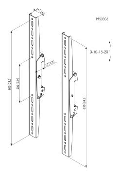
PFS 3306 ist für mittelgroße bis große Displays bis 80 kg Gewicht und einem max. vertikalen Passbereich von 600 mm geeignet. Kombinieren Sie diese Displayadapter mit einer Connect-it Deckenkonsole (PUC 1060/ 1070/ 1080/ 1090), einem Connect-it Rohr (PUC 2508/ 2515/ 2530) und einer Connect-it Adapterleiste (PFB 3405/ 3407/ 3409/ 3411) zu einer Komplettlösung für die Deckenbefestigung.
