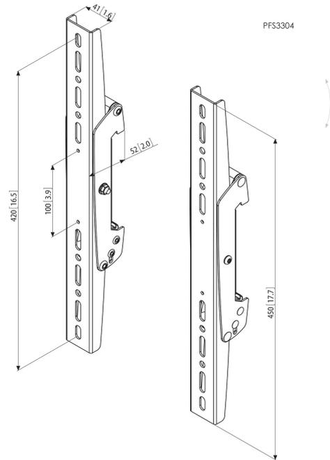
PFS 3304 ist für mittelgroße bis große Displays bis 80 kg Gewicht und einem max. vertikalen Passbereich von 420 mm geeignet. Kombinieren Sie diese Displayadapter mit einer Connect-it Deckenkonsole (PUC 1060/ 1070/ 1080/ 1090), einem Connect-it Rohr (PUC 2508/ 2515/ 2530) und einer Connect-it Adapterleiste (PFB 3405/ 3407/ 3409/ 3411) zu einer Komplettlösung für die Deckenbefestigung.
