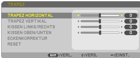
Sie können die horizontale oder vertikale Trapezverzerrung, die Kissenverzeichnung RECHTS/LINKS oder OBEN/UNTEN oder die Eckenverzerrung manuell korrigieren.
